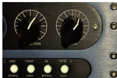
4 Chaque voie dispose de quatre switches.
